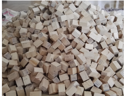
Figure 2. Test specimens for examining the physical properties of wood / Slika 2. Testni primjerci za mjerenje fizičkih karakteristika drveta
